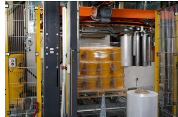
Weniger Folienverbrauch und Eliminierung des Energieträgers Gas durch neue Wickelstreckanlage in der Produktion in Stühlingen.
